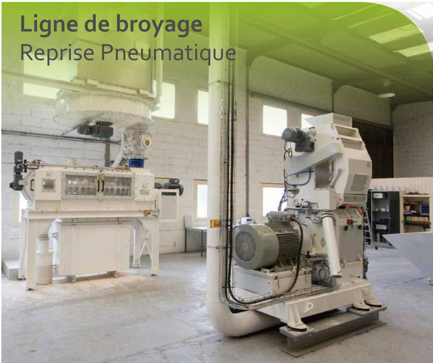
L'air entre par l'alimentateur ABMS et par une entrée d'air additionnelle. Il traverse les grilles du broyeur.
