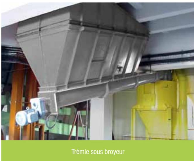
Trémie sous broyeur
