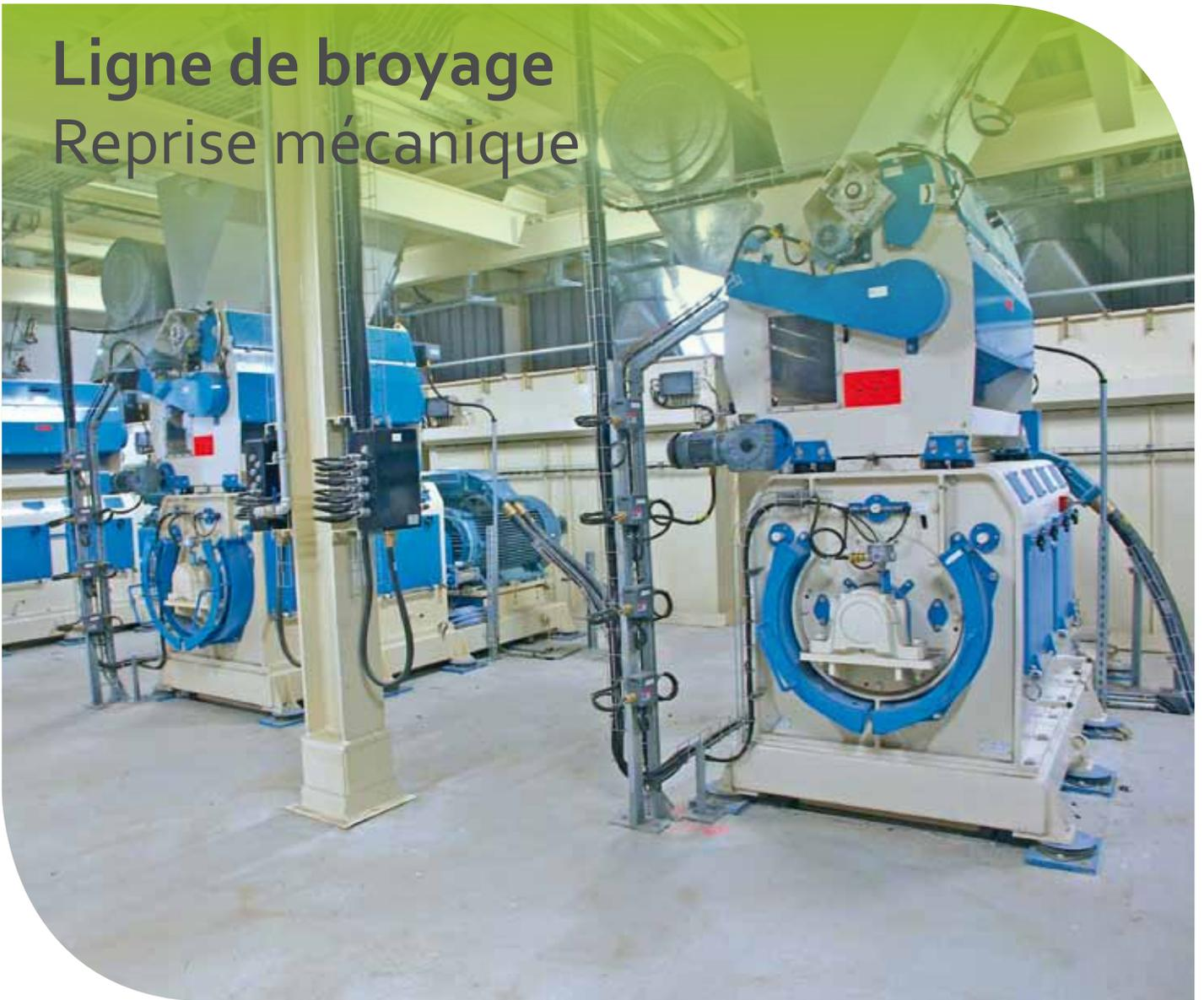
Les broyeurs type RMP et RMA sont généralement installés sur un plancher béton ou métallique et fixés par des plots anti-vibratiles.
